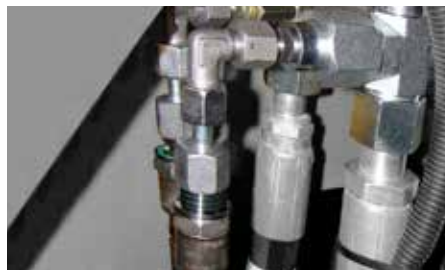
Digitale olietrykssensorer med overbelastningssikring og integreret temperaturkontrol og letmonterede skrueforbindelser.
