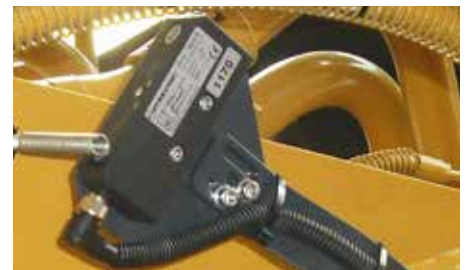
Nærhedsafbrydere for en dynamisk vejning under drift og en pålidelig definition af vejeområdet og enkel montering.
