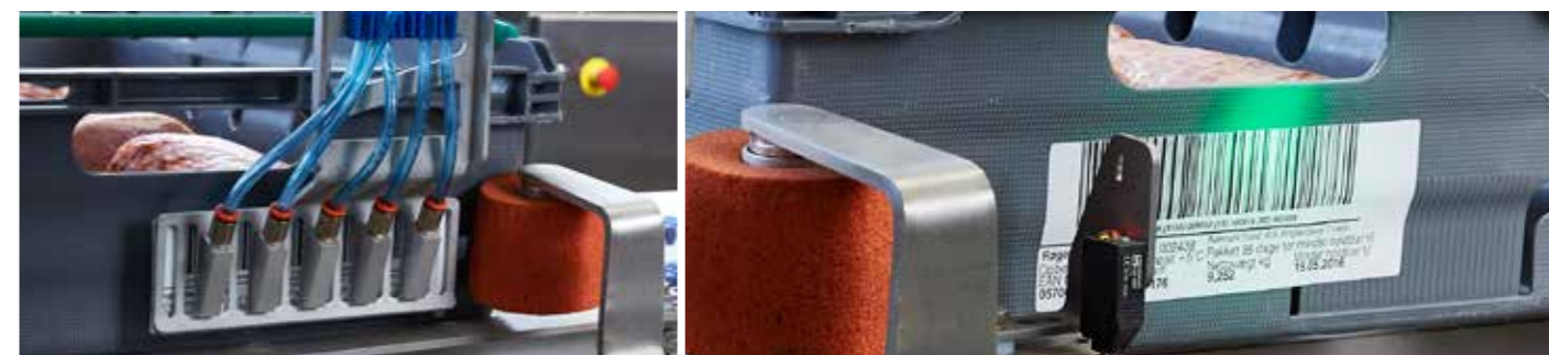
Automatyczna regulacja wysokości naklejania etykiet
