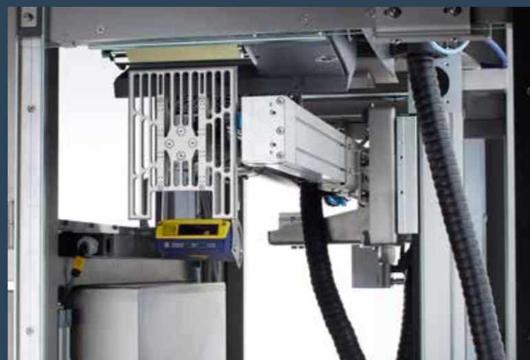
Serwomechanizm zapewnia sprawne i precyzyjne naklejanie etykiet
