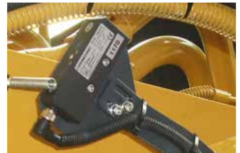
Nærhetsbrytere for dynamisk veiing under drift, pålitelig definisjon av veieområdet og enkel montering.
