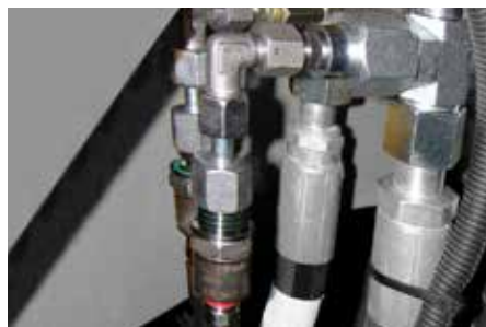
Digitale oljetrykksensorer med overbelastnings-sikring, integrert temperaturkontroll og lett-monterte skruerforbindelser.
