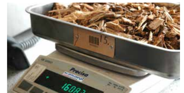
Flisprøve vejes på laboratorievægt og vægtresultat sammenkobles med ID-nr. og ekspeditionsnr.
