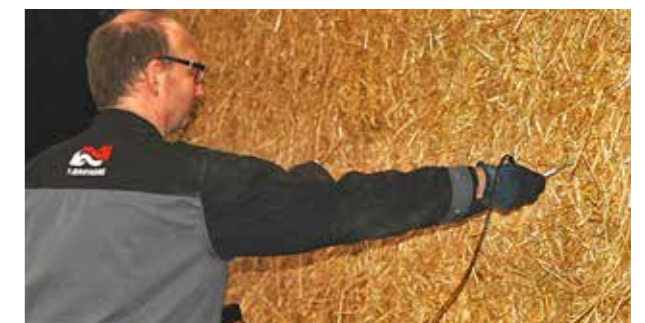
Ved halmleverancer måles fugtighedsprocent, som overføres til Energy Calculation på PC.
