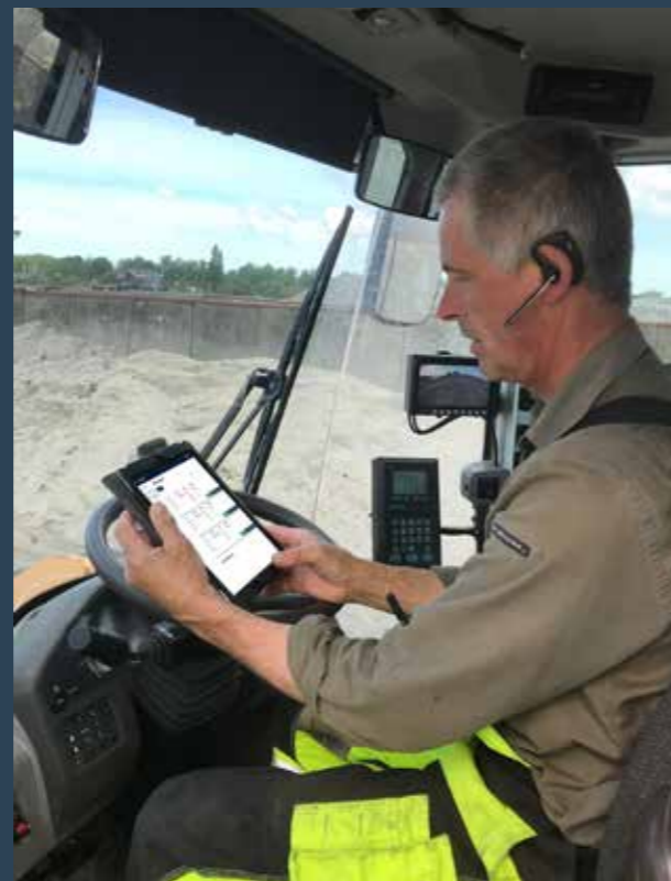
Med ScanLoader-modulen registrerar operatören materialets vikt, som han levererar till lastbilen, på sin surfplatta eller smartphone.
