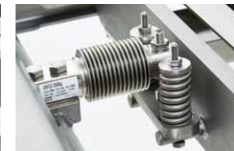
Układ przeciwwstrząsowy chroniący ogniwo obciążnikowe
