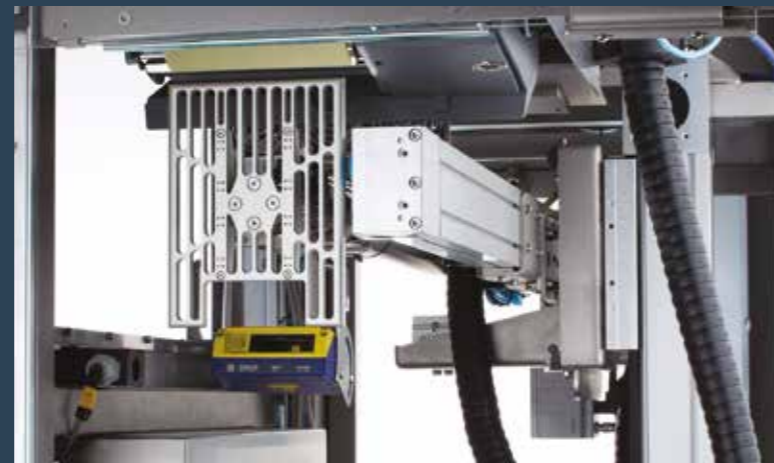
Servo-motoren sikrer rask og presis etikettpåsetting
