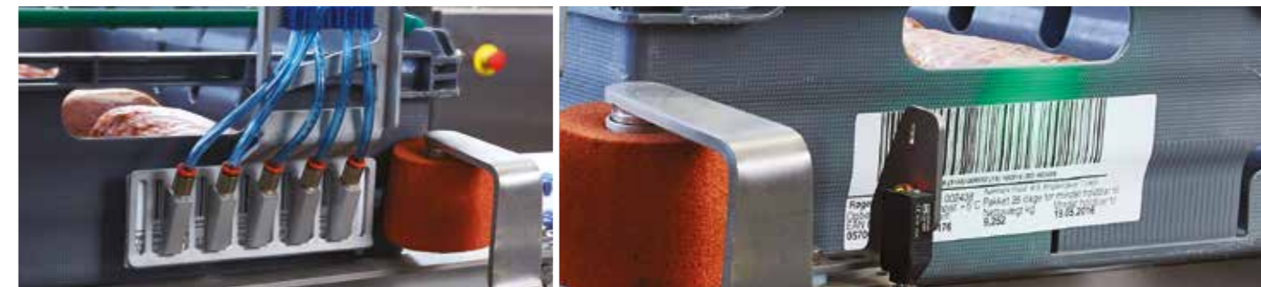
Automatisk høydejustering av etikettpåsetting
