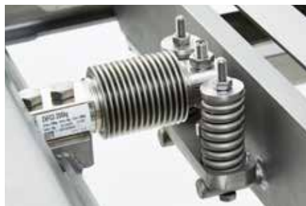
Antischock als Schutz für die Wiegezone
