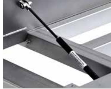
Enkel öppning av plattform med hjälp av gasfjäder
