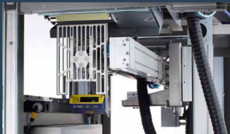
Servo-motoren sikrer hurtig og præcis etiketpåsætning
