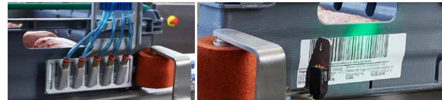
Automatisk højdejustering af etiketpåsætning
