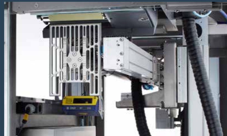
Servo-motoren sikrer rask og presis etikettpåsetting
