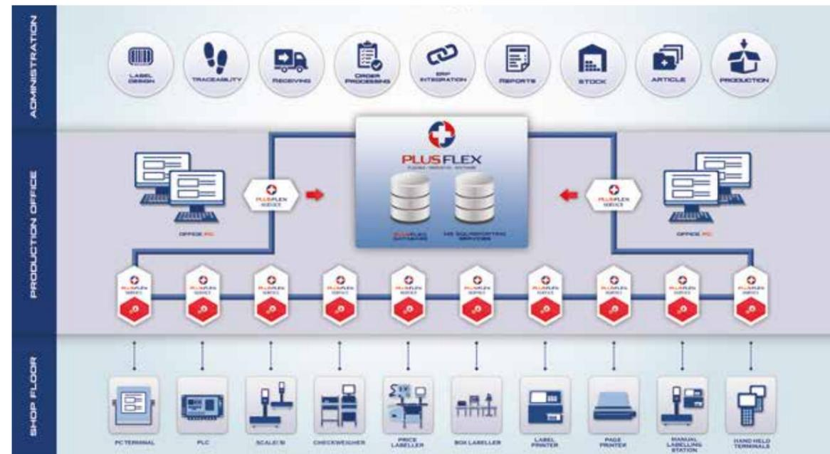
Plusflex ist aus Modulen aufgebaut und besteht aus einer Reihe von Standardmodulen, u. a.:
