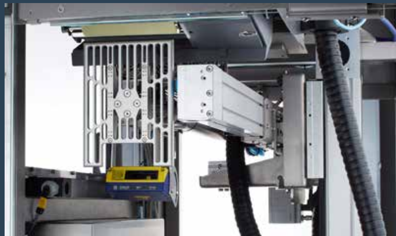
Servomotorn säkrar en snabb och exakt etikettering
