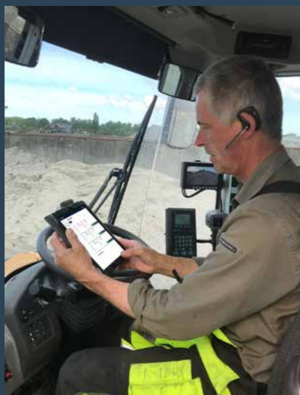
Med ScanLoader-modulen registrerer operatøren vekten av materialet som han utleverer til lastebilen, på sitt nettbrett eller smarttelefon.
