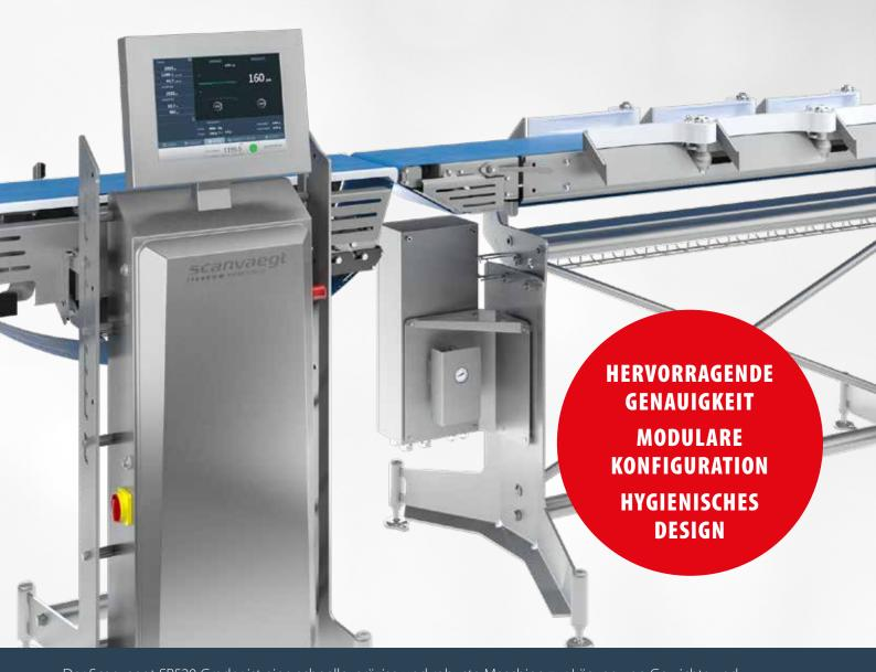
Der Scanvaegt SP520 Grader ist eine schnelle, präzise und robuste Maschine zur Lösung von Gewichts und Größenerkennungen von verschiedensten Produkten der Nahrungsmittelindustrie. Die Maschine verwiegt die Produkte dynamisch und bestimmt dabei die Einzelgewichte, mit einer Geschwindigkeit von bis zu 130 Artikel pro Minute. Der SP520 Grader ist in drei Standardkonfigurationen erhältlich, die unterschiedliche Produktionsanforderungen bedienen.
