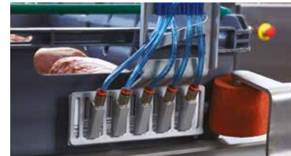
Automatische Anpassung der Höhe der Etikettenanbringung
