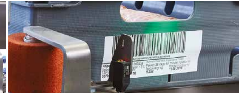
Automatischen Qualitätskontrolle des Etiketts
