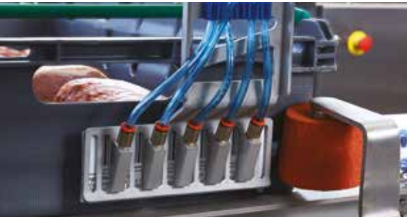
Automatisk højdejustering af etiketpåsætning
