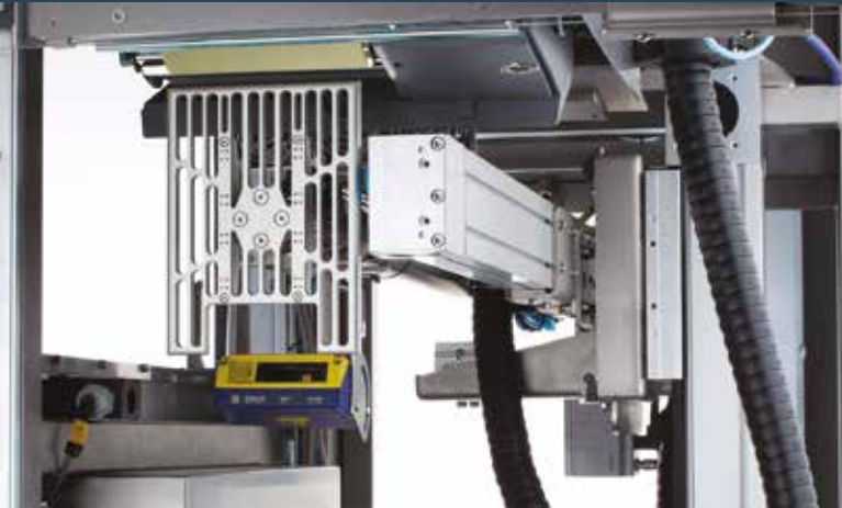
Servo-motoren sikrer hurtig og præcis etiketpåsætning
