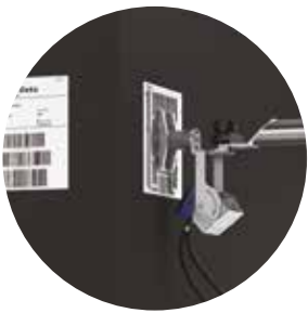
Automatisk etiketpåsætning på en, to eller tre sider og i 32 forskellige højder
