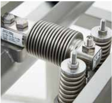
Hermetisk forseglet, rustfri stålvejecelle
