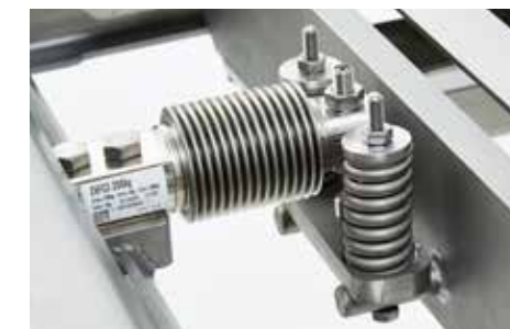
Antischock als Schutz für die Wiegezelle
