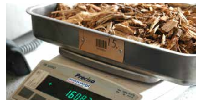
Flisprov vägs på laboratorievåg och viktresultatet kopplas till ID-nummer och expeditionsnummer.
